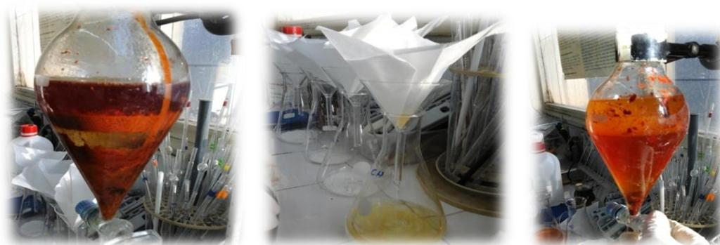
**Figure N°16:** Extraction liquide-liquide
