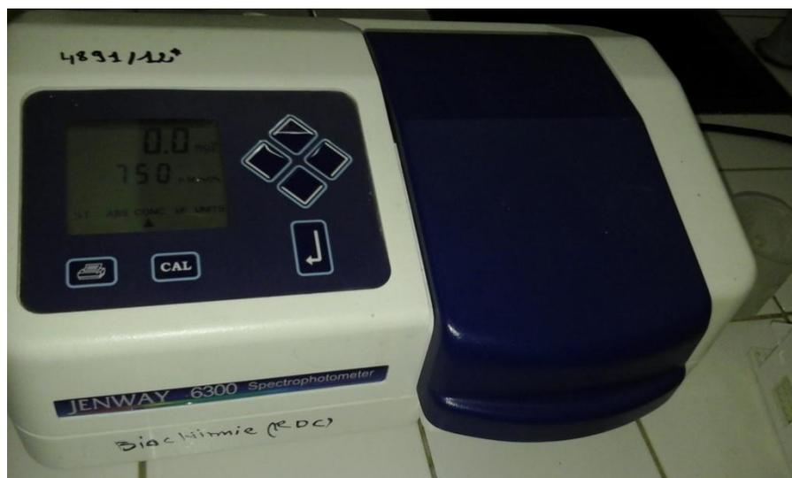
**Figure N°59: le spectrophotomètre UV, JENWAY 6300 BIOCHIMIE (RDC).**
