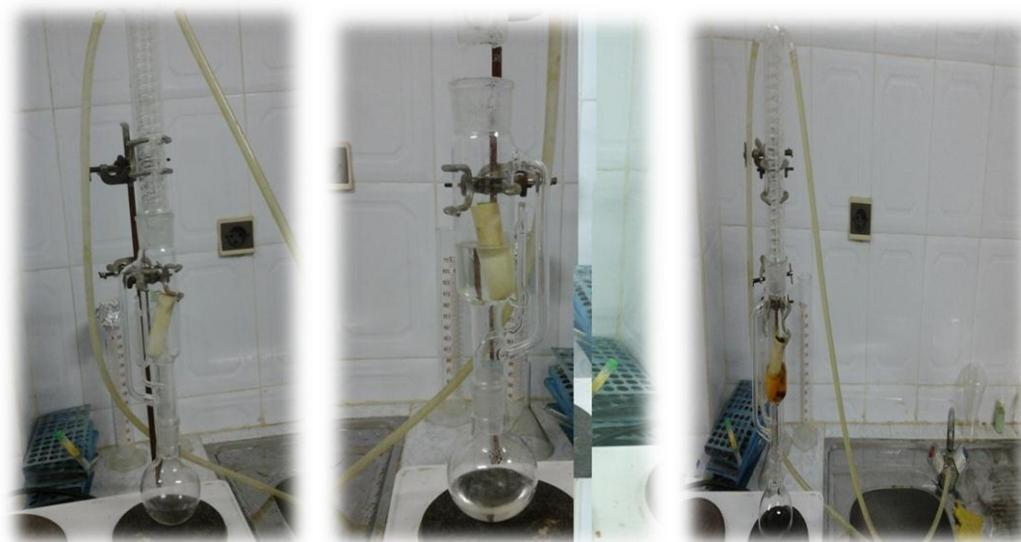
**Figure N°14 :** Extraction par Soxhlet.
